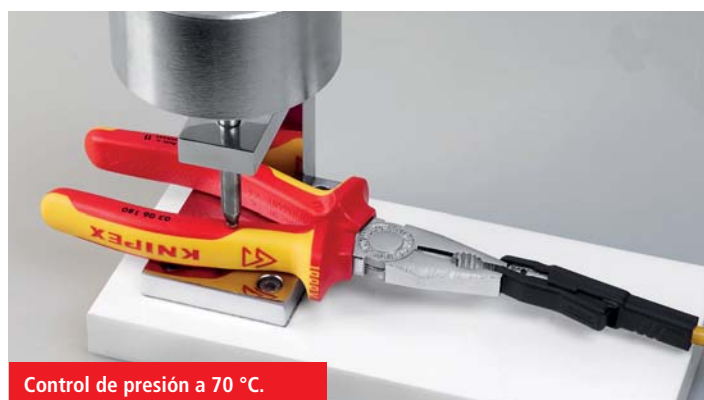
Control de la capacidad de adherencia de las fundas VDE con 500 N a 70 °C
