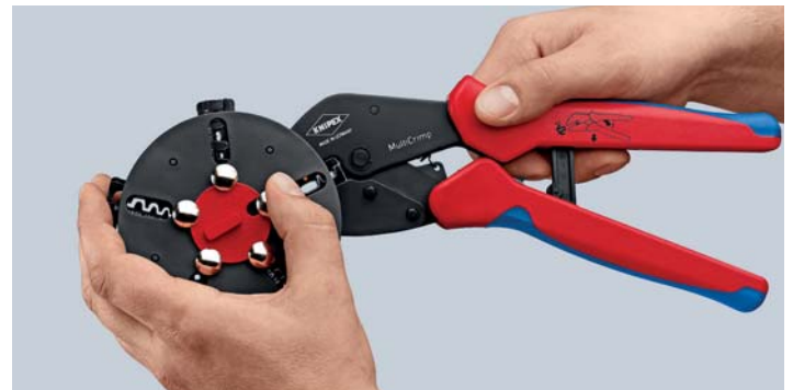
Cambio de la mordaza de entallaje: desbloquear la posición del almacén, extraer la mordaza de entallaje del alicate
