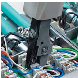
Corta y presiona en una sola operación
