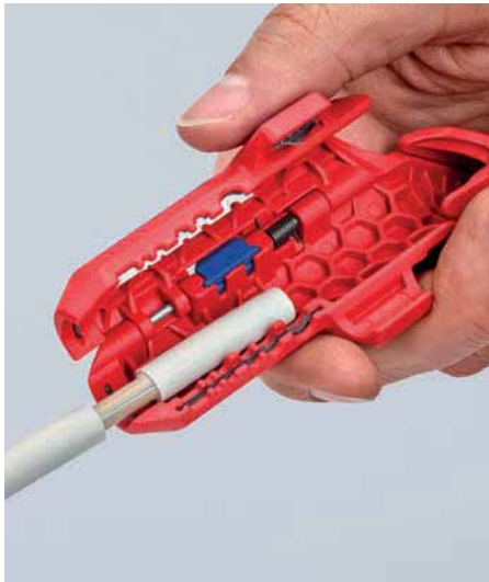
Pelar un cable NYM
