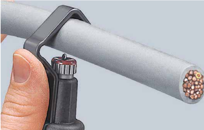
Colocar la herramienta para corte circular
