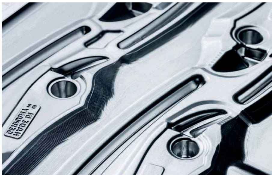
Matriz para los alicates de corte diagonal tipo extra fuerte con eje articulado forjado.
