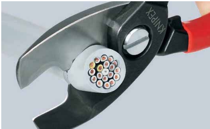
Corte final: Después de haber cortado el aislamiento del cable con el filo delantero, los conductores se cortan en el perfil trasero. Corte inicial delante, corte final atrás – de este modo se corta con más facilidad
