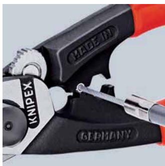
Prensar el terminal al cable de tracción
