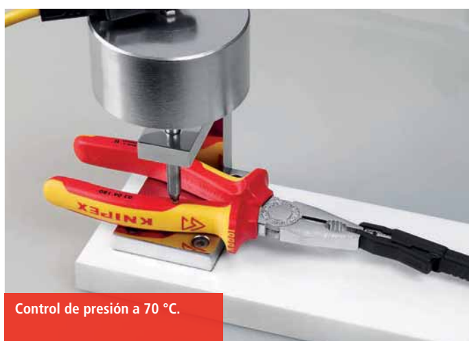
Control de la capacidad de adherencia del revestimiento aislante con 500 N.
