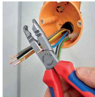
Realizar cortes al acortar conductores individuales
